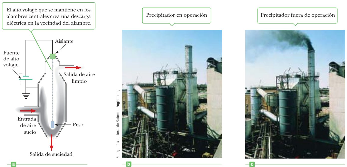
Figura 16.12 a) Diagrama de un precipitador electrostático. Compare la contaminación del aire cuando el precipitador b) opera y c) se apaga.
