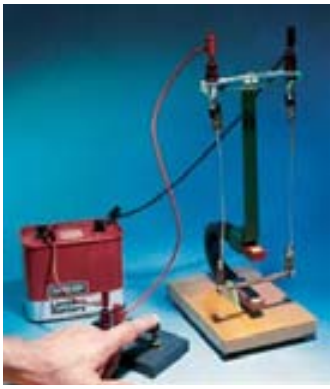
Figura 19.9 Este aparato demuestra la fuerza sobre un conductor portador de corriente en un campo magnético externo. ¿Por qué la barra se balancea alejándose del imán después de cerrar el interruptor?
