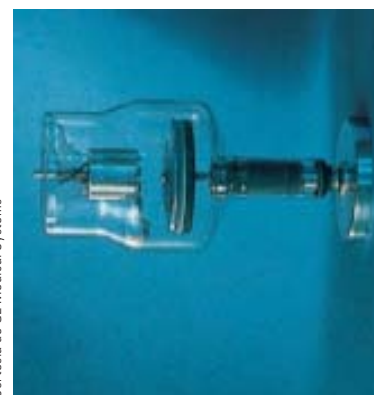
Figura 27.8 a) Diagrama de un tubo de rayos X. b) Fotografía de un tubo de rayos X.
