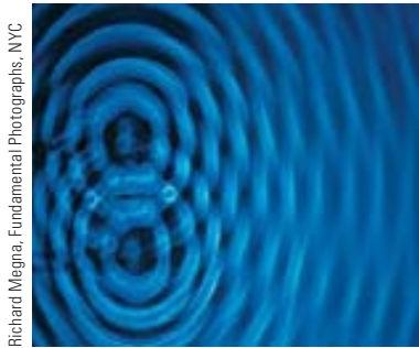
Figura 24.2 Un patrón de interferencia que involucra ondas de agua se produce mediante dos fuentes vibratorias en la superficie del agua. El patrón es análogo al que se observa en el experimento de doble rendija de Young. Observe las regiones de interferencia constructiva y destructiva.
