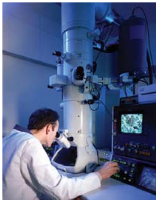
Figura 27.17 a) Diagrama de un microscopio electrónico de transmisión para ver una delgada muestra seccionada. Las “lentes” que controlan el haz de electrones son bobinas de desviación magnéticas. b) Microscopio electrónico.
