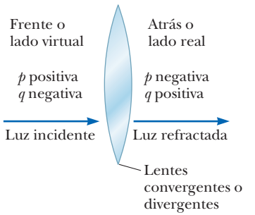
Figura 23.24 Diagrama para obtener los signos de p y q para una lente delgada o una superficie refractante.
