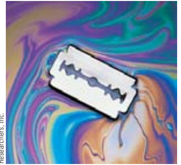
Una película delgada de aceite sobre agua muestra interferencia, lo que se evidencia mediante el patrón de colores cuando luz blanca incide sobre la película. Las variaciones en el grosor de la película producen el patrón de color que interseca. La navaja de rasurar proporciona una idea del tamaño de las bandas coloridas.
