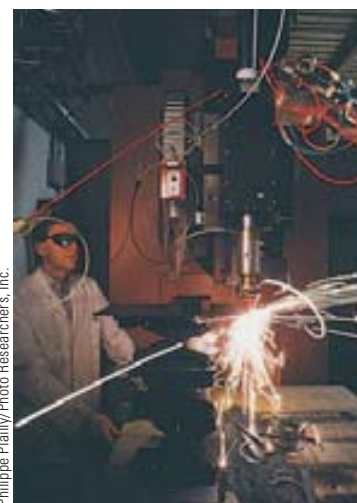
Un científico comprueba el desempeño de un dispositivo experimental de láser montado en un brazo robótico. El láser se usa para cortar a través de una placa metálica.
